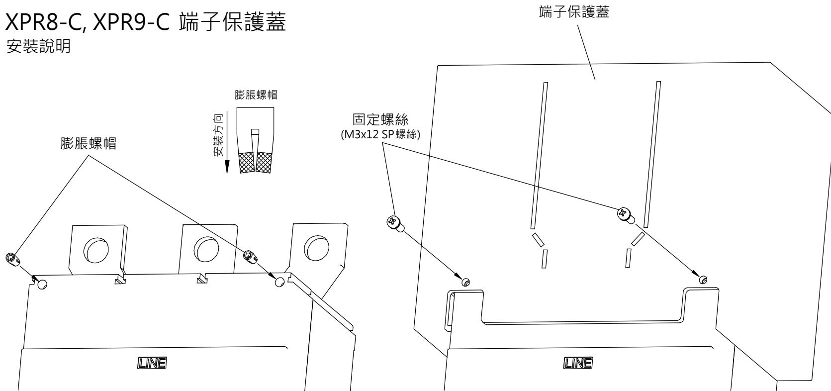
1. 將膨脹螺帽壓花端朝下，依箭頭方向放置到上蓋兩側安裝端子保護蓋的沉孔內。
